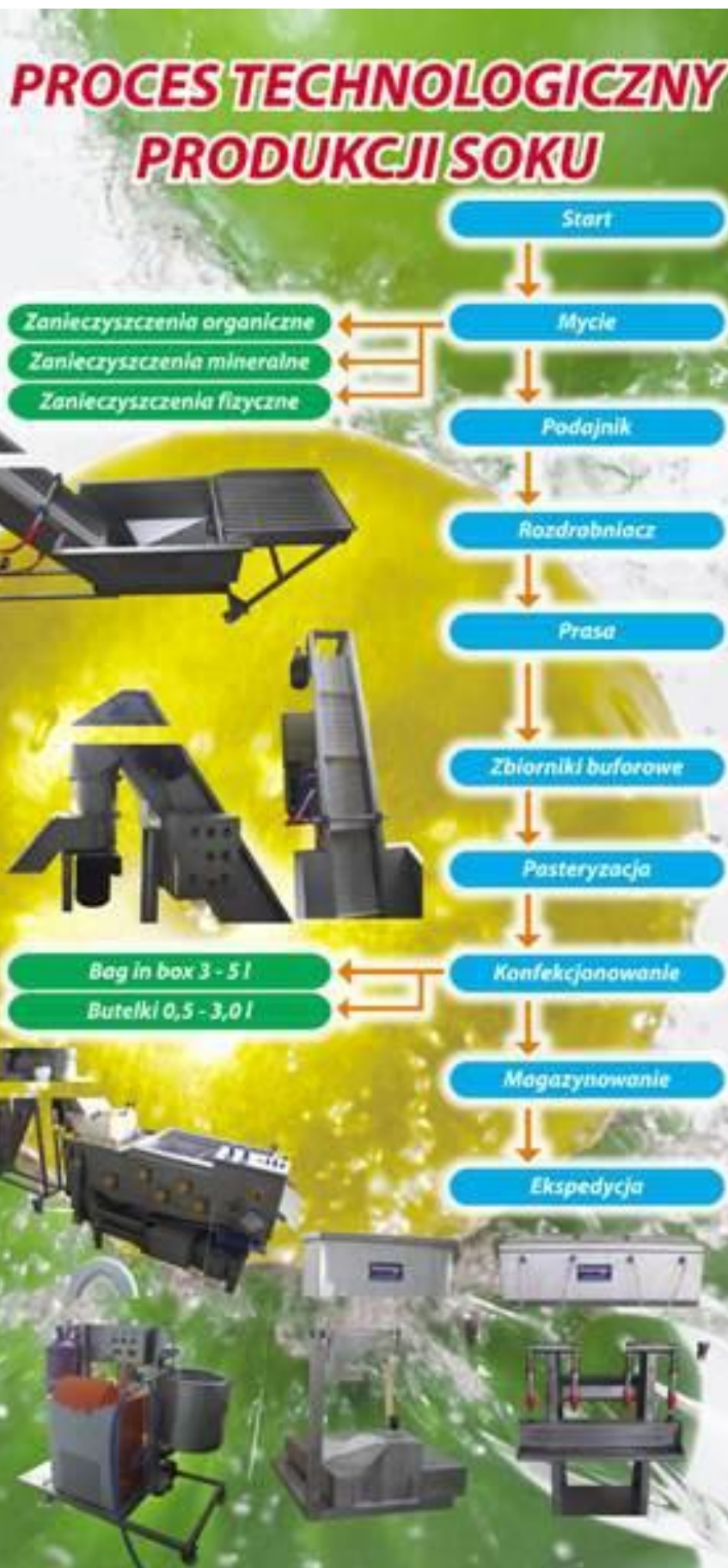
Rys. 27. Linia produkcji soku w CDR O/Radom [źródło: materiały CDR]
